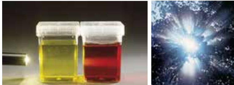
شکل ۱ اثر تیندال، آ) مقایسه پخش نور در محلول و کلویید. ب) نمونه‌ای از مشاهده اثر تیندال در زندگی روزانه پرتوهای خورشید در هوای مه‌آلود یا آلوده به غبار
